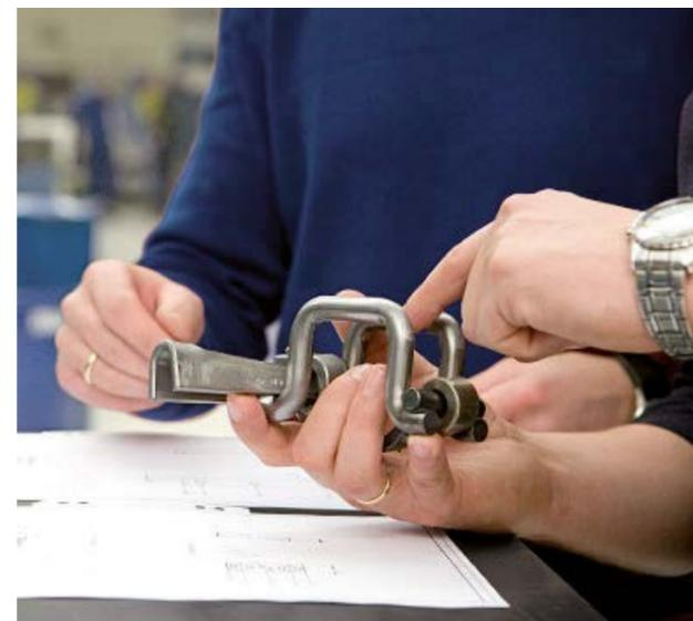
Le terme « technique de découpage et cambrage » désigne un procédé de fabrication par séparation et formage. Ce procédé consiste à transformer un ou plusieurs produits semi-finis, comme une bande ou un fil métallique, en un produit fini sur une seule machine de production.
