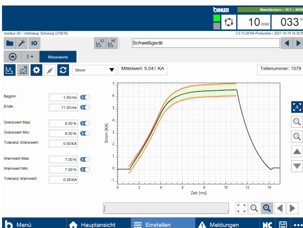
Grenzwertüberwachung von Messwertkurven
