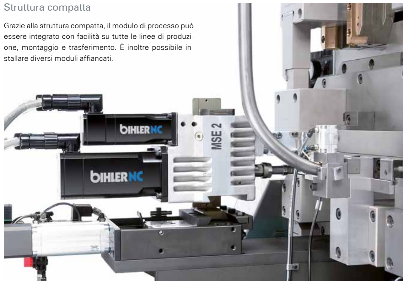
MSE 2 con dispositivo di innalzamento integrato - sistema parziale (rendimento 120/min.)
