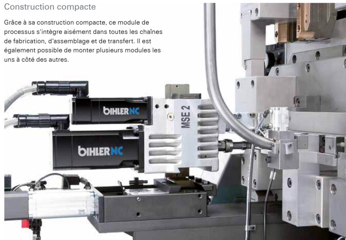
MSE 2 avec dispositif de levage intégré sous forme de système partiel (cadence de production 120/min)
