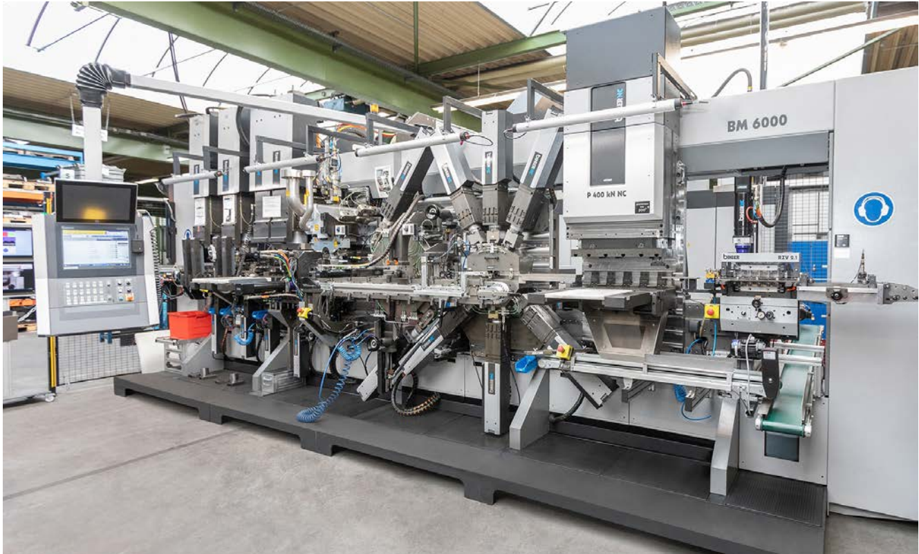
Das neue Servo-Produktions- und Montagesystem Bimeric BM 6000 von Bihler bietet ein Höchstmaß an Automation und Effizienz. Alle Arbeitsschritte werden darauf inline in einem durchgängigen Prozess ausgeführt.
