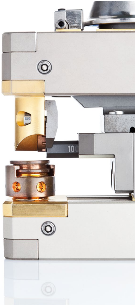
Coupe par électrode de fil rond
