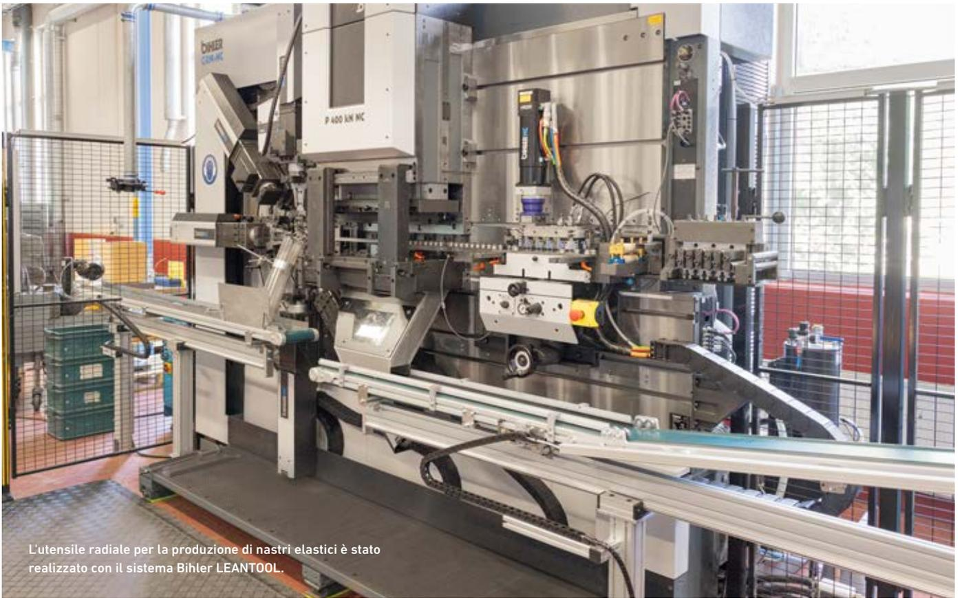
L'utensile radiale per la produzione di nastri elastici è stato realizzato con il sistema Bihler LEANTOOL.
