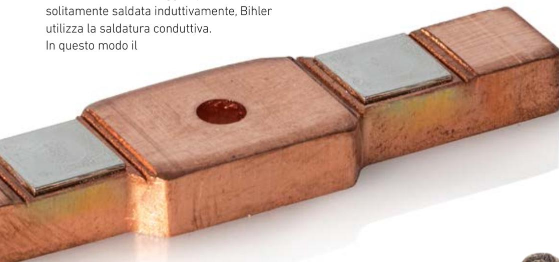
Con il nuovo processo di saldatura a resistenza conduttiva, le strisce di rame fino a 5 mm di spessore possono essere dotate di contatti di dimensioni fino a 10 x 10 mm.
