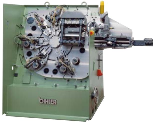
Il sistema modulare Bihler con saldatura e assemblaggio si basa sulle trancia-piegatrici RM 35 e GRM 50.
