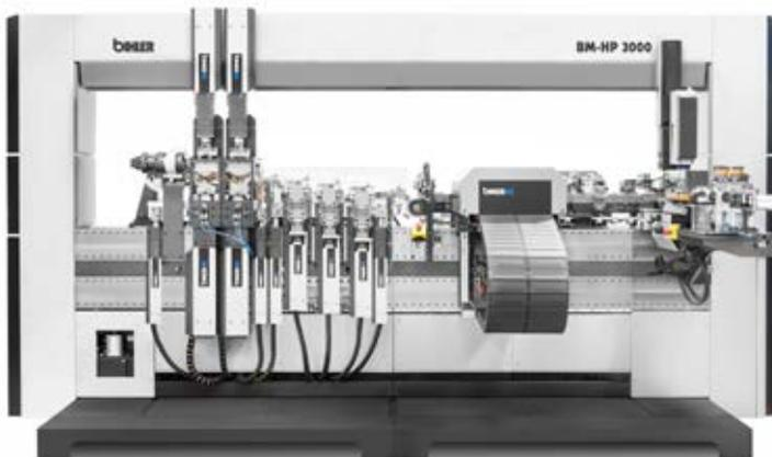
Con il BM-HP 3000, Bihler offre una soluzione altamente automatizzata per la produzione di hairpin per motori elettrici.
