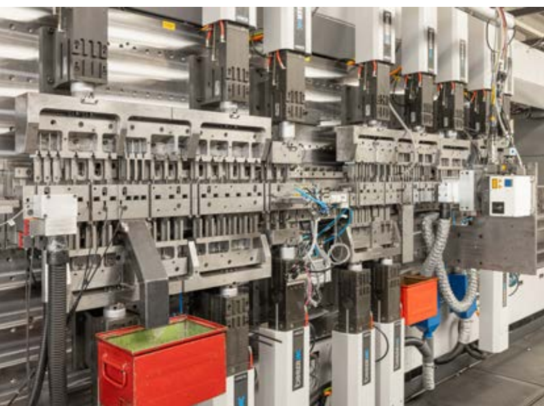
Die Steckerfertigung umfasst auf der Bihler BIMERIC BM 4500 insgesamt rund 100 verschiedene Arbeitsschritte.
