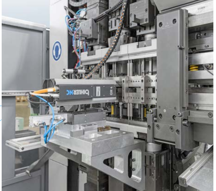
Das Linearwerkzeug für die neue Bihler GRM-NC wurde von Industrias Huerta selbst entwickelt.
