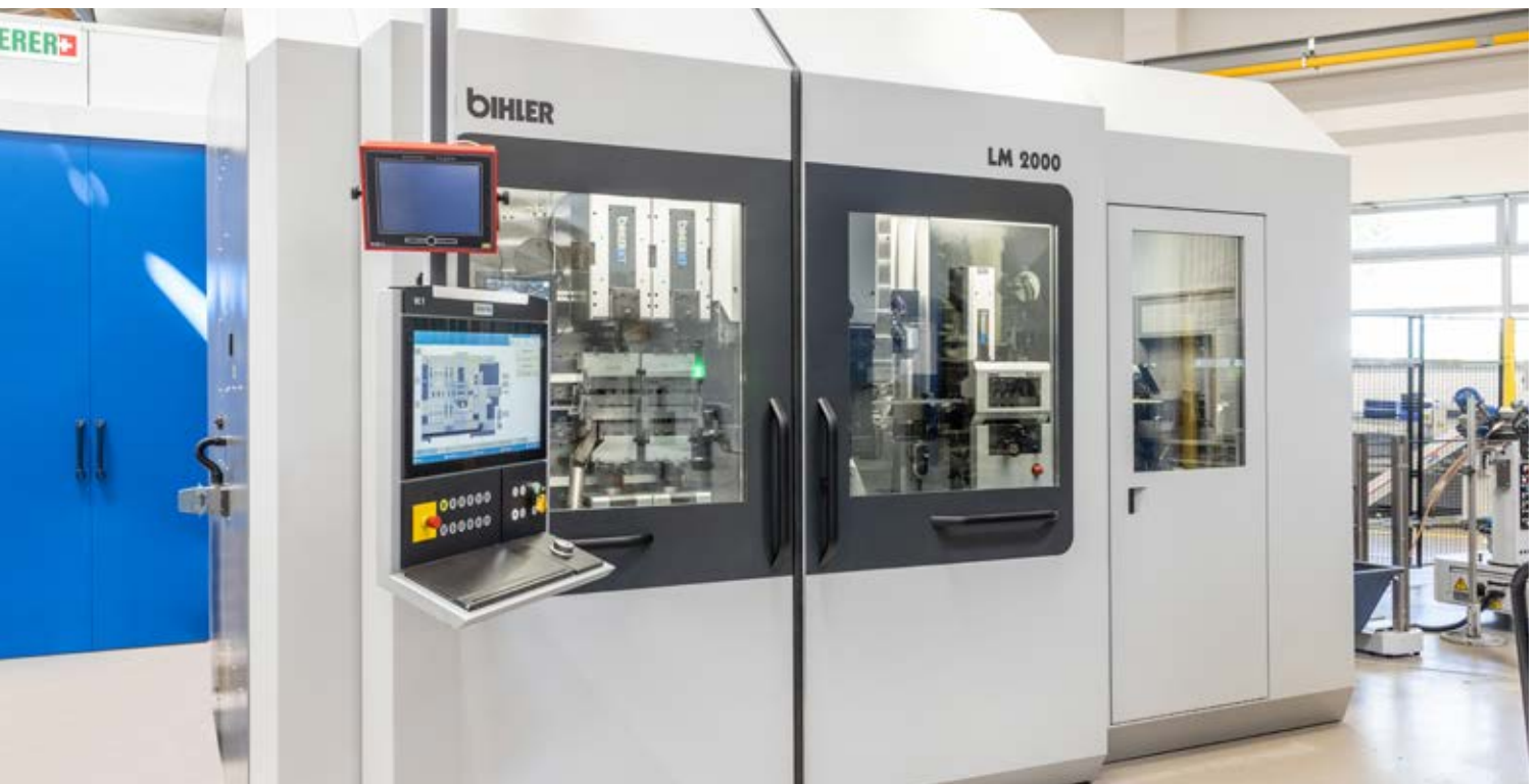
Nuova macchina ad alte prestazioni: La Bihler LM 2000-KT produce contatti in scatola per circuiti stampati presso il Gruppo DRÄXLMAIER a circa 400 corse al minuto.
