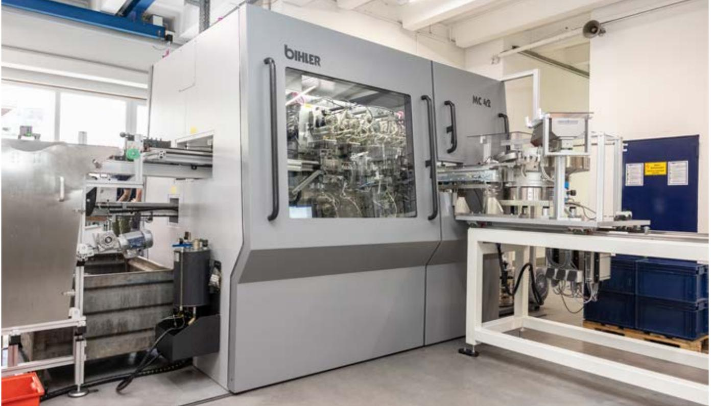
**En los multicentros Bihler, prácticamente todos los pasos del proceso se realizan en la banda y no en cada componente. Esto permitió realizar a la perfección el aumento necesario de la frecuencia de los ciclos, manteniendo al mismo tiempo la máxima calidad de los componentes.**
