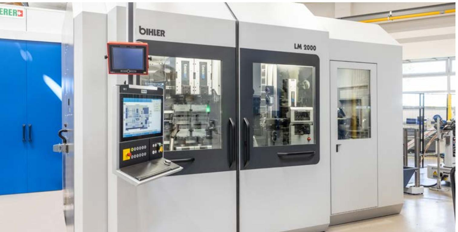
**Nueva máquina de alto rendimiento: La Bihler LM 2000-KT produce contactos de borde para placas de circuitos en el Grupo DRÄXLMAIER a unas 400 carreras por minuto.**
