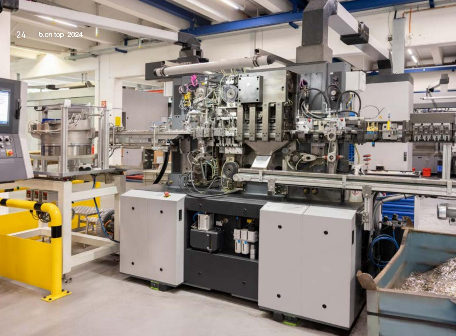
La empresa fabrica los soportes de puesta a tierra y los contactos de protección para las tomas de corriente GIRA de los multicentros Bihler. La solución ofrece capacidad para más de 35 millones de componentes al año.
