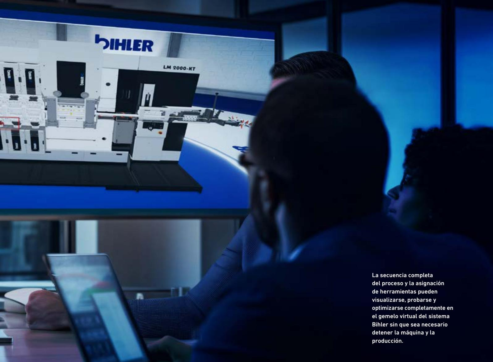
La secuencia completa del proceso y la asignación de herramientas pueden visualizarse, probarse y optimizarse completamente en el gemelo virtual del sistema Bihler sin que sea necesario detener la máquina y la producción.
