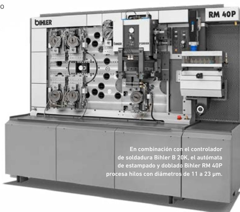
En combinación con el controlador de soldadura Bihler B 20K, el autómatas de estampado y doblado Bihler RM 40P procesa hilos con diámetros de 11 a 23  $\mu\text{m}$ .
