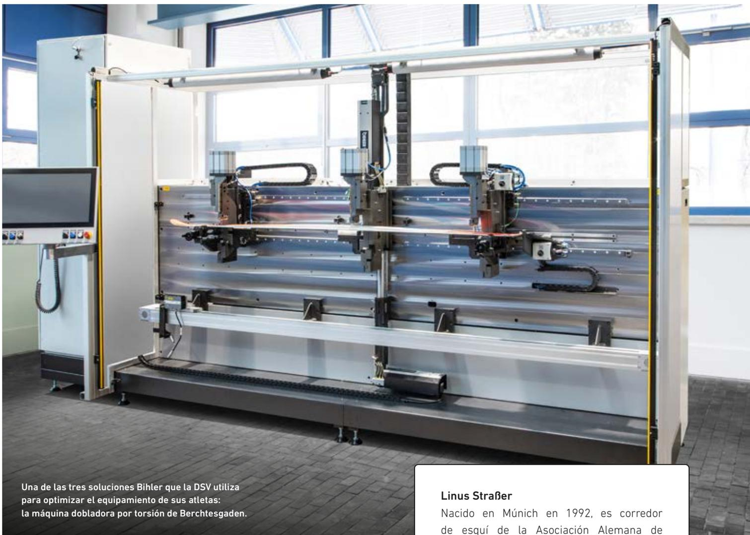
Una de las tres soluciones Bihler que la DSV utiliza para optimizar el equipamiento de sus atletas: la máquina dobladora por torsión de Berchtesgaden.
