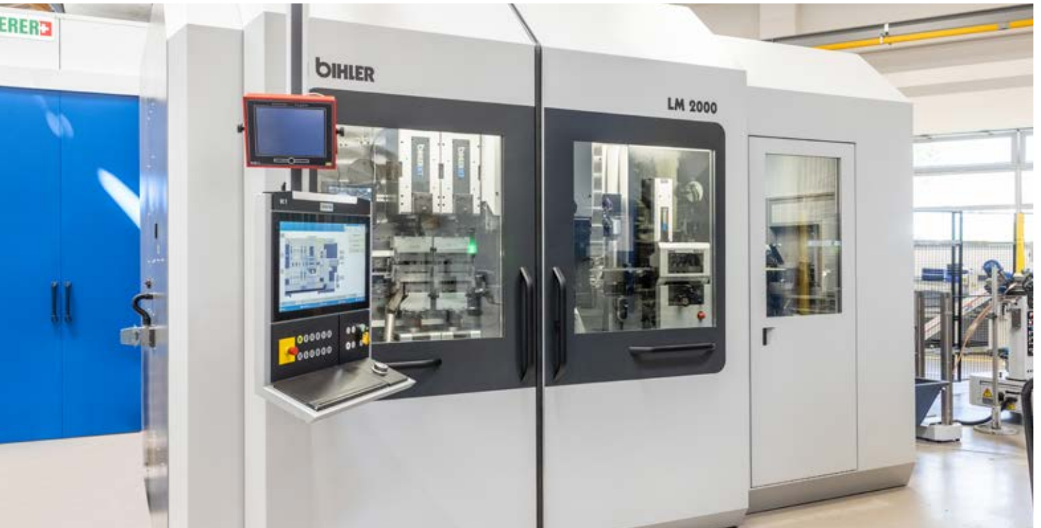
Neue Hochleistungsmaschine: Die Bihler LM 2000-KT fertigt bei der DRÄXLMAIER Group Kastenkontakte für Platinen mit rund 400 Hüben pro Minute.
