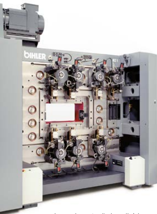
Le premier centre d'usinage linéaire de formage BZ constitue la pierre angulaire d'une fabrication efficace de sous-ensembles.
